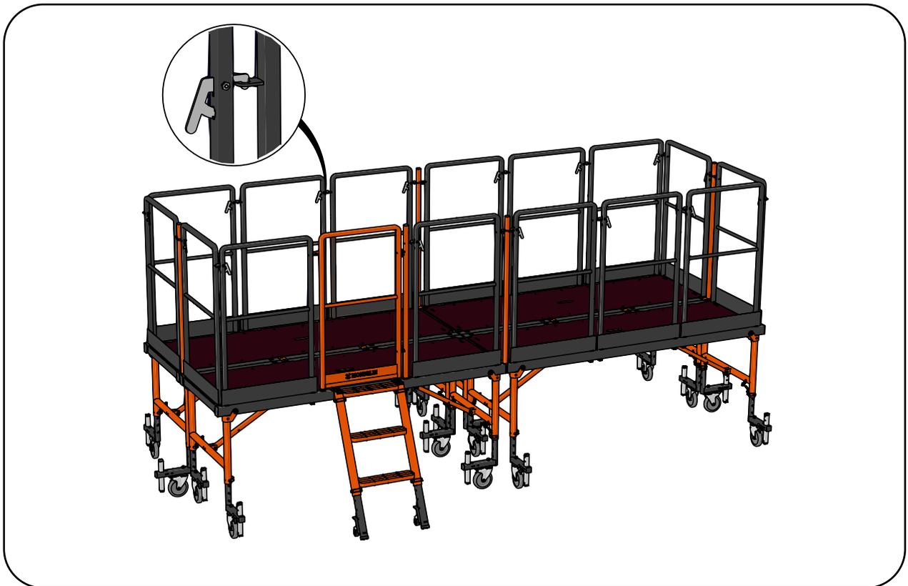
À tout moment le portillon et un garde-corps peuvent être intervertis pour s'adapter à la configuration du travail à réaliser.
